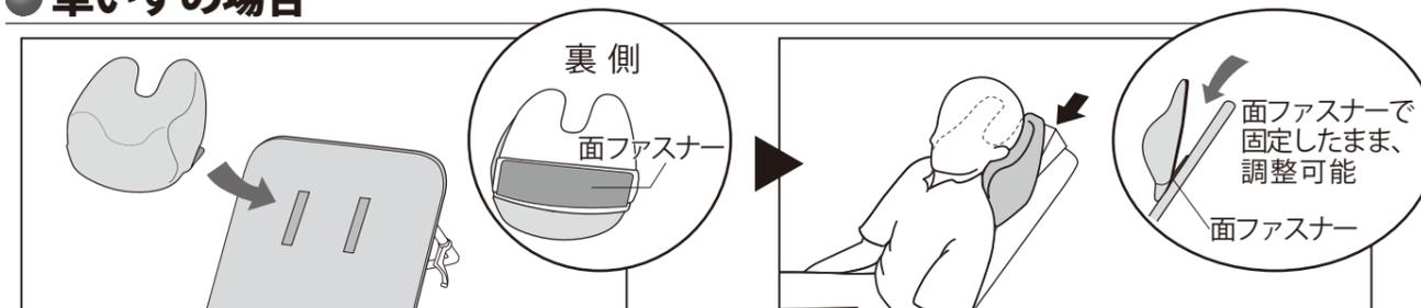
① 車いすのヘッドレストを外し、マクラ裏側の面ファスナーをベルトから出します。クビマクラの面ファスナーと車いす背シートの面ファスナーを合わせて固定します。
